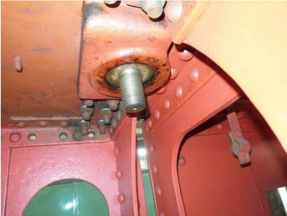
Abb. 28 Wiederaufbau Lok DEV 7 s oberer Gelenkbolzen-Fuß von rechts
